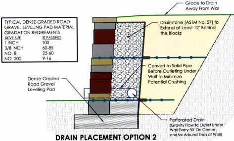
THIS DETAIL IS INTENDED FOR USE WHERE GRAVITY DRAINAGE ONLY AVAILABLE TO THE BOTTOM OF THE EXPOSED WALL FACE
